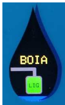
Tela 4: Mostra o estado da chave bóia (Ligada ou Desligada). Quando operando através de chave bóia.
