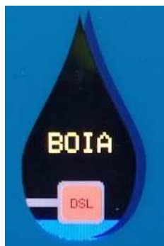
Tela 4: Mostra o estado da chave bóia (Ligada ou Desligada). Quando operando através de chave bóia.
