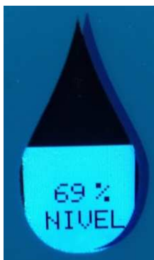
Tela 4 : Mostra o percentual do nível do reservatório com ilustração gráfica. Quando operando com sonda de nível.
