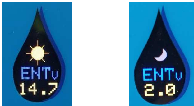
Tela 2: Leitura da tensão de entrada do painel solar, mostra também se está operando em modo diurno (sol) ou noturno (lua). Quando em modo noturno o equipamento opera em modo de economia de bateria.
