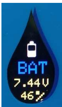
Tela 3: Leitura da tensão da bateria e visualização de percentual de carga
