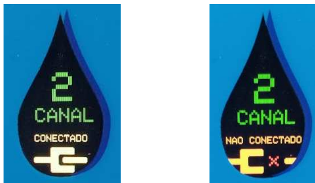
Tela 1: Mostra Canal de RF e se há ou não conexão com o rádio receptor
